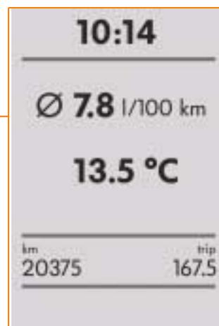
Комбинация приборов модели Highline позволяет вывести на дисплей дополнительно к указанным выше данным (для модели Midline)
