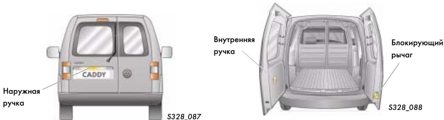
Открывание дверей начинается с левой створки. Ручка замка левой створки встроена в рамку фонаря освещения номерного знака. Правая створка открывается после поворота блокирующего рычага, расположенного в ее нижней части. Створки двери фиксируются при их повороте на 90°. Если освободить ограничители, створки можно распахнуть на 170°, доведя их до упоров.
